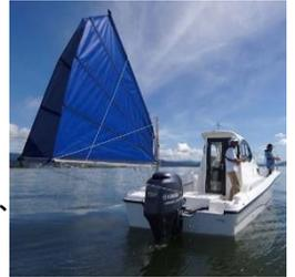
短いマストで橋梁下の容易な潜り抜けと、
